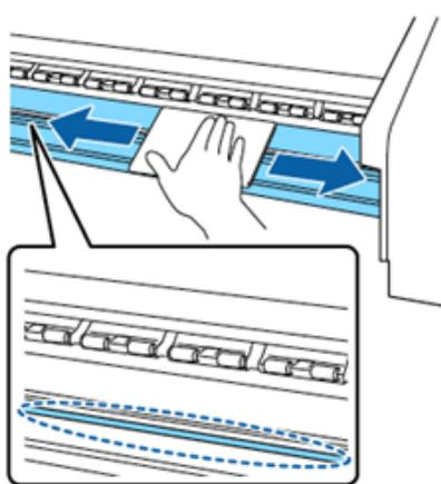
Il est nécessaire de nettoyer quotidiennement la zone de chauffage du cylindre. À l'aide d'un chiffon doux humidifié, il s'agit d'essuyer la surface afin de retirer les fibres et la poussière pouvant être collées à cet endroit. De la même manière, il faut nettoyer les plaques de bord de support.
